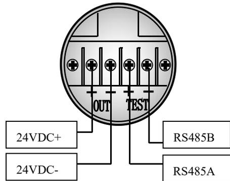
在电磁干扰较严重的场合，建议使用屏蔽导线，并妥善接地。信号线不要与其它电源线一起穿金属管或放在同一线槽中，也不要再在强电设备附近通过。
